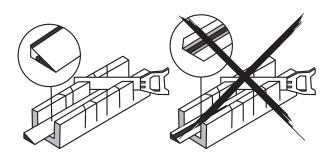
Декоративную алюминиевую накладку и базовый профиль необходимо подрезать таким образом, чтобы их длины были одинаковыми.
